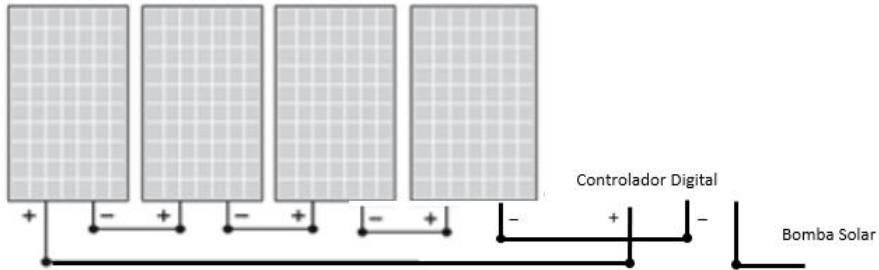
4 paneles solares de 550W
